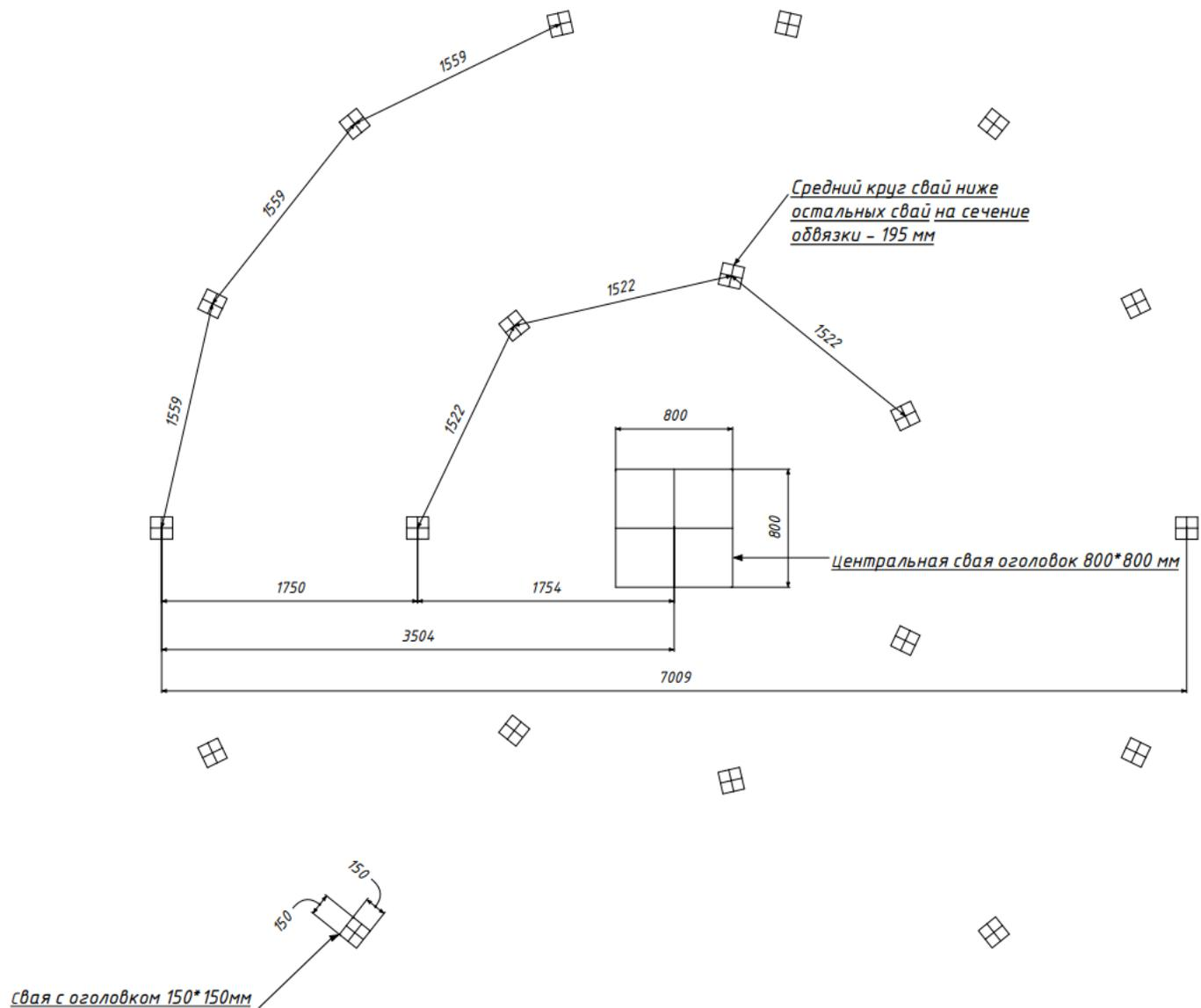
Примечание. Все размеры указаны по оси. При монтаже проконтролировать высотные отметки. Сваи минимум +300 мм от земли в нижней точке. Для крыльца можно использовать блоки в качестве фундамента.
