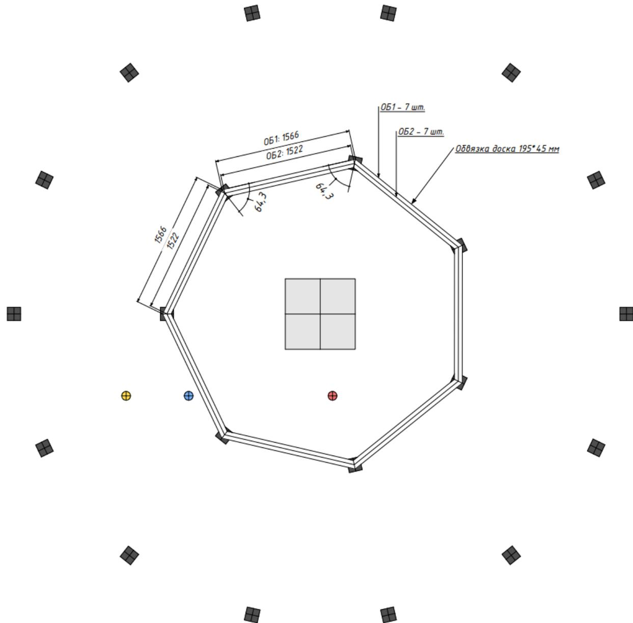
Примечание. Необходимо сделать отсечную гидроизоляцию между обвязкой и оголовками свай.
